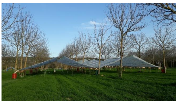
Photographie du grand dispositif d'exclusion de pluie ©Guillaume Blanchet
